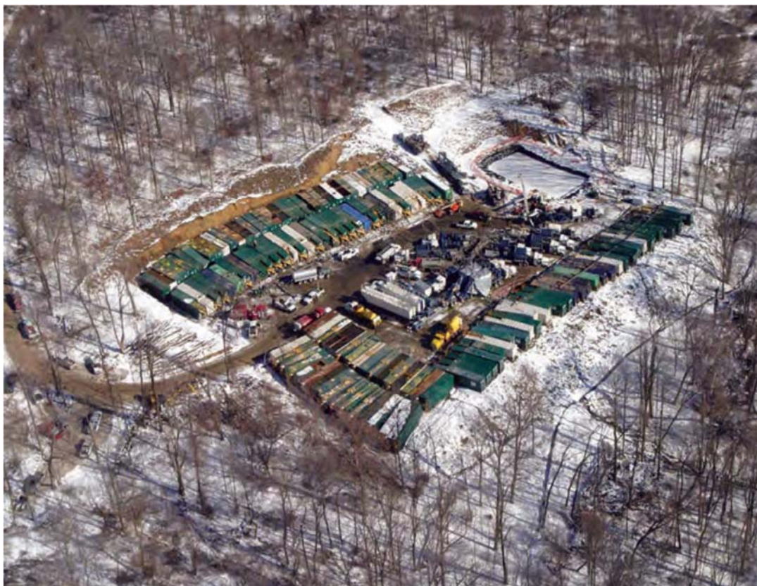
Figura 13. Estimulación por fracking de un pozo de gas de esquisto en Marcellus. Obsérvese la cantidad de equipo móvil (camiones) utilizado (año 2007). Fuente: Soeder DJ & Kappel WM. 2009. Water Resources and Natural Gas Production from the Marcellus Shale . USGS science for a changing world.
